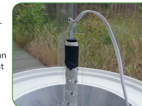
De lichtsensor wordt bevestigd aan de schroef.
