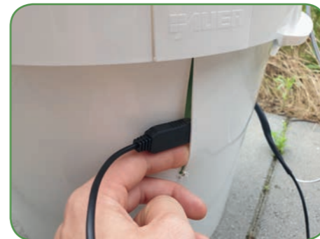
Open de sleuf een beetje met je vingers zodat de USB-aansluiting erdoorheen kan.
